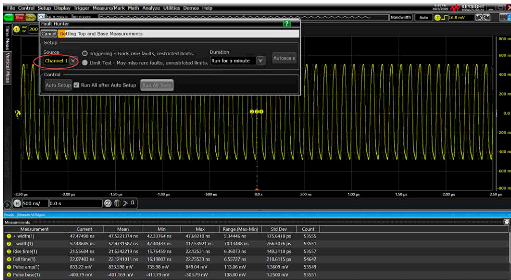
图 3. 任何一个通道都可以运行 Fault Hunter，生成常见测量值的平均值和标准偏差的基线
