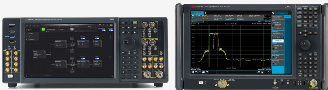
图 1. 这种 5G 测试台配置支持高达 44 GHz 的 3GPP NR 信号创建（左下），并包括高达 50 GHz 的台式频谱分析能力（右），二者都拥有完整的 1 GHz 带宽。
